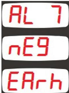
Alarm 7 : Negative (-) earth leakage alarm
