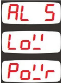
Alarm 5 : Low Power (kW) Alarm
